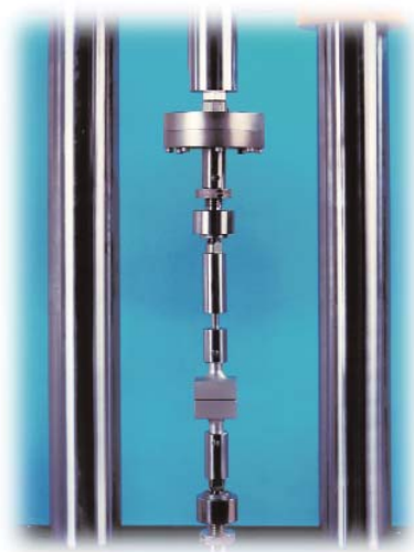
▲ Stud pull test fixture
